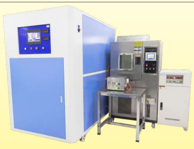
Elektrische Lebensdauer-Prüfgeräte für Luftschalter (Dient zur Überprüfung der Einhaltung der geltenden UL- und CE-Normen)
