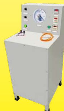
Kontrolle der Luftschalter-Betriebszyklen
