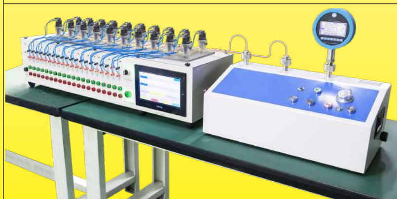
Überprüfung der Druckschalterkalibrierung
